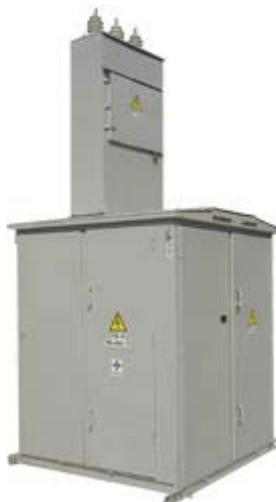
КТП-25 является киосковой подстанцией мощностью 25 кВА, поставляется в проходном или тупиковом исполнении. Устройство принимает трехфазный переменный ток промышленной частоты напряжением, равным 10 или 6 киловольт с преобразованием напряжения до 0,4 киловольт для снабжения конечных потребителей.
