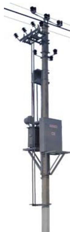
КТПС 25/10/0,4 – комплектная трансформаторная подстанция. Выпускается в столбовом исполнении. Установка - наружная. Тип – тупиковый, мощность – 25 кВА. Принимает трехфазный переменный ток частотой 50 Гц номинальным напряжением 10 и 6 кВ и преобразует его в электроэнергию номинальным напряжением 0,4 кВ и распределяет ее между потребителями.
