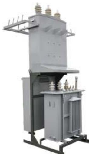
Предназначение мачтовой комплектной трансформаторной подстанции КТП-250 – это прием электрической энергии трехфазного переменного тока с частотой 50 Гц (6 или 10 кВ). С последующим его преобразованием в электрическую энергию, напряжение которой на выходе будет составлять 0.4 кВ. Затем полученной электроэнергией снабжаются потребители. Используемый вольтаж более 1000В.
