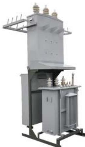
Мачтовые комплектные трансформаторные подстанции КТПМ - 100 применяются для приема электроэнергии от ЛЭП напряжением 6 или 10 кВ и частотой 3-хфазного переменного тока 50 Гц для последующего распределения и передачи потребителям электроэнергии напряжением 0,4 кВ.
