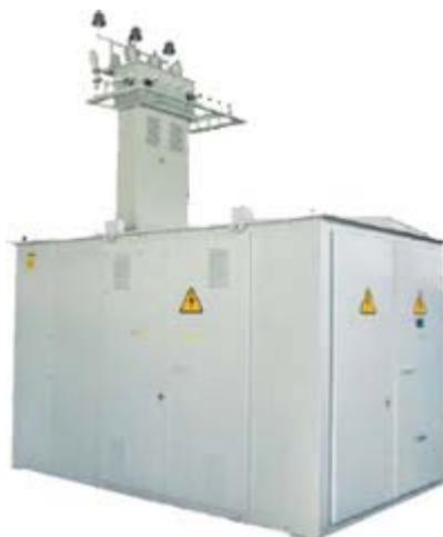
Комплектная трансформаторная подстанция КТП-400 предназначена для осуществления электроснабжения потребителей суммарной мощностью до 400 кВА. По типу исполнения КТП подразделяются на внутренние (шкафные) и наружные (киосковые), по подключению вводной части - на проходные и тупиковые.
